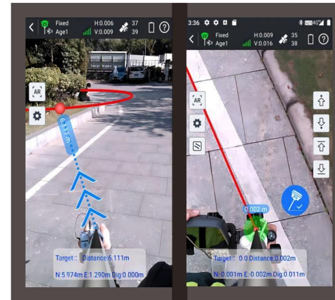
Los usuarios utilizan las imágenes en tiempo real capturadas por la cámara en la parte inferior del receptor y las líneas guía AR mostradas por el software para localizar los puntos objetivo.
